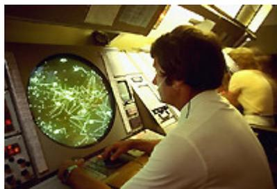
Le radar secondaire est destiné au contrôle "en route" et a une portée typique de 250NM.
