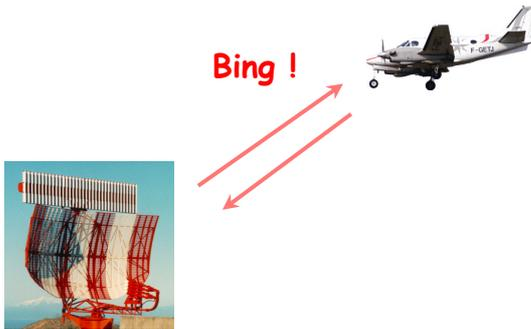
Le temps d'aller-retour ainsi que l'orientation de l'antenne lors de sa réception permettent de situer l'écho, visualisé sur un écran radar.
