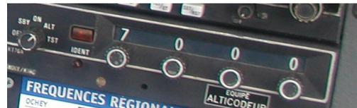
Il envoie à l'avion une interrogation à laquelle le **transpondeur** de bord fournit une réponse.
